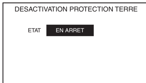
Figure 47 – Écran d'arrêt de désactivation protection terre
